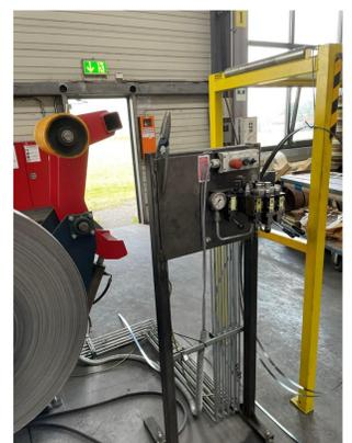
Vereinheitlichung von Stellteilen (Kombination elektrischer und hydraulischer Bauteile) und ergonomische Gestaltung (Höhe)
