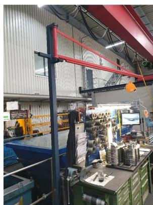
Schwenkarm reduziert die Belastung beim Ein- und Ausbau des Schneidwerkzeuges
